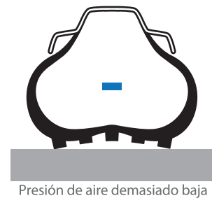
Presión de aire demasiado baja
